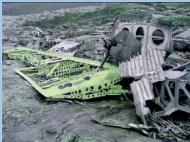
▲ Überreste der linken Tragfläche auf dem Kvitnosi, die später geborgene Außentragfläche ist gelb markiert. Foto: G. Böttcher
