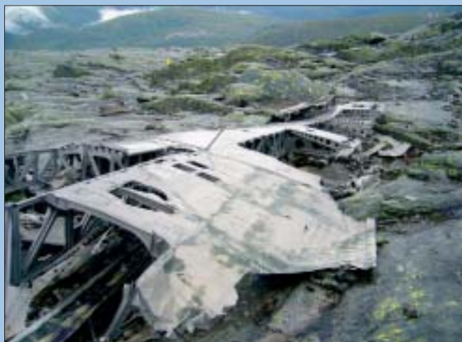
▲ Reste der rechten Tragfläche auf dem Kvitnosi. Die Flügelhinterkante ist stark zerstört. Foto: G. Böttcher
